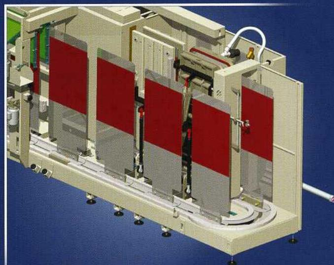
1 - Cambio forme pneumatice/Pneumatic change of forms/échange pneumatique des formes/Cambio neumático de formas/Пневматическая смена форм/Рпomatik kalыр deđiptirme
